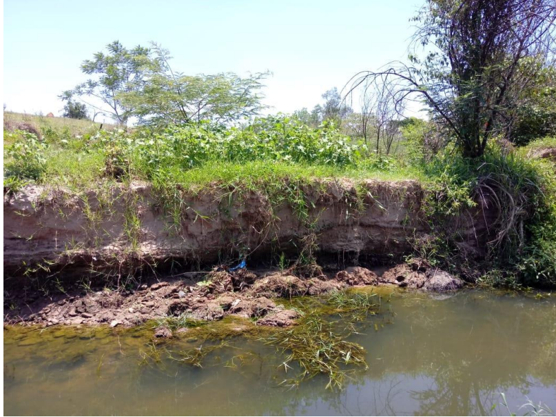
Foto 11. Perfil de solo nas margens do córrego (Seção 3) / Camadas antigas de depósito tecnogênicos.
